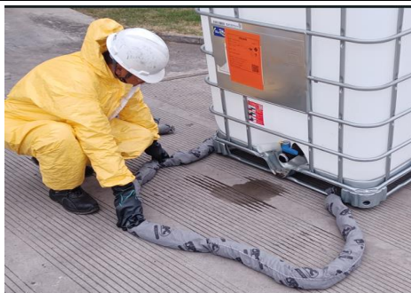
对泄漏点进行围围挡
