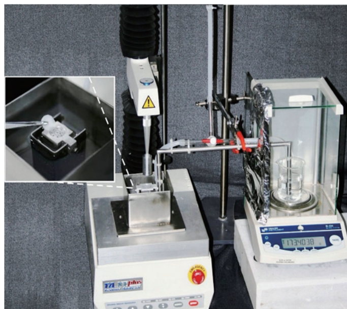
图 1. 崩解力测试仪 (右边为天平, 左边为质构仪。)
