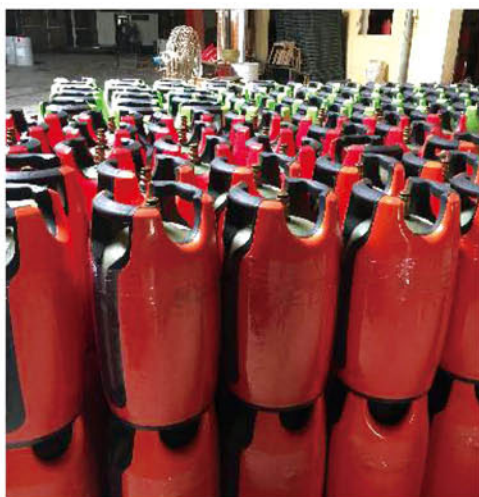
Derakane™8090 环氧乙烯基酯树脂材料天然气罐
